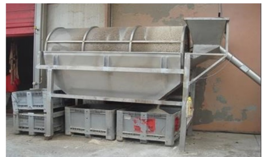
Figura 2 - Equipamento para filtração de sal recuperado
